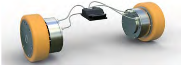
Heinzmann AGV-Antriebssystem: Die Motorcontroller sind exakt auf das Antriebssystem zugeschnitten und übernehmen zusätzlich zur Geschwindigkeitskontrolle die Funktionen elektronisches Differenzial, Torque Vectoring, Rückspeisung im Bremsbetrieb etc.
