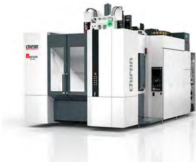
Die Chiron DZ 22 W five axis mit einem Spindelabstand von 600 Millimetern wurde als Antwort auf aktuelle Kundenanforderungen aus der Automobilindustrie entwickelt.
