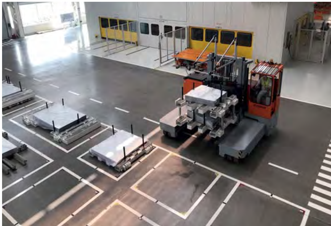
Der Stapler mit kurzem Gabelträger ist erste Wahl, wenn es darum geht, kompakte Waren millimetergenau durch das Lager zu manövrieren.
