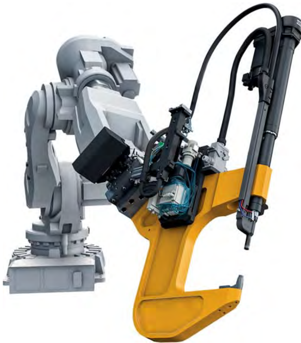
Henrob-Stanznietwerkzeug aus der Unity-Serie an einem Roboter. Halblinks am C-Rahmen ist ein Dual-Niet-Magazin montiert, rechts das Setzwerkzeug. Die Niete werden nach vorne an die Spitze des Setters geschossen und in die zu fügenden Lagen getrieben. Eine Matrize dient als Gegenhalter. Sie sitzt am unteren Ende des ‚C‘. Bild: Atlas Copco
