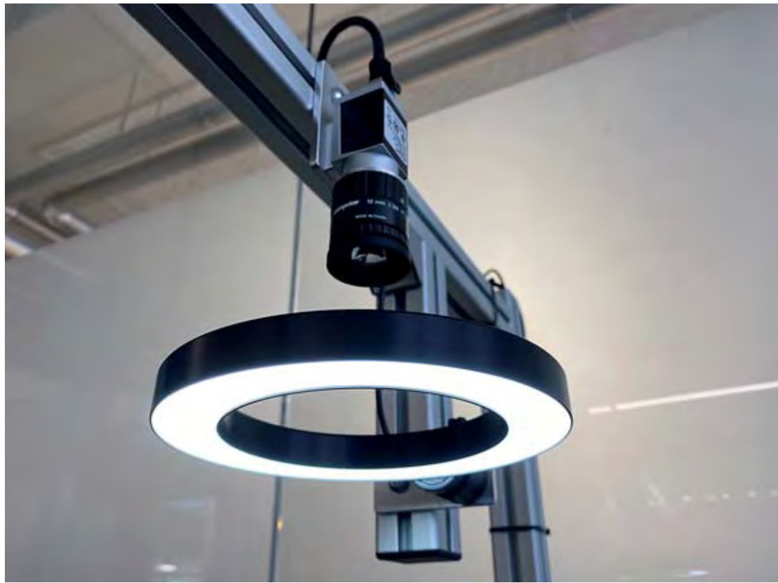
Hier Kamera- und Beleuchtungssystem zur Bilderfassung von Oberflächen. Deep Learning vereinfacht die Analyse.
