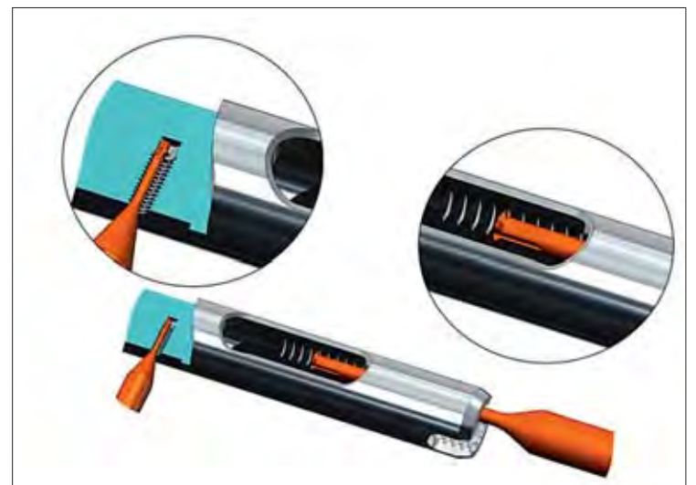
Mit den neuen Werkzeugen von Dieterle können Innengewinde im Ø-Bereich M0,7 und kleiner realisiert werden.
