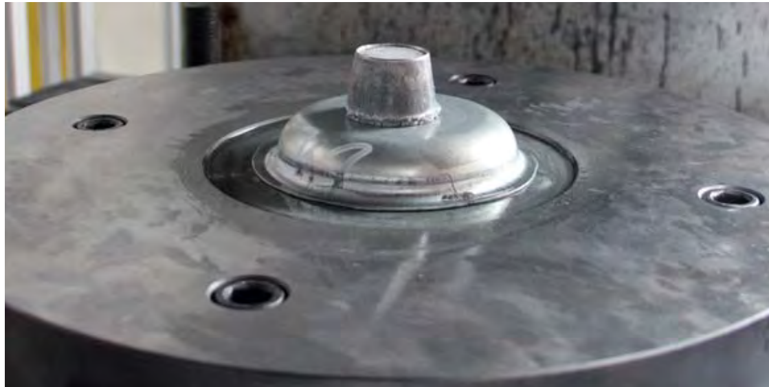
Schmieden statt Schweißen: Bei diesem Versuchsbauteil wurde ein Aluminiumbolzen und ein Stahlblech durch Umformung verbunden, anschließend wurde das Blech tiefgezogen. Bild: IPH Hannover
